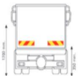
Modelo 1: Kit de 2 paneles de 595x132 mm.
